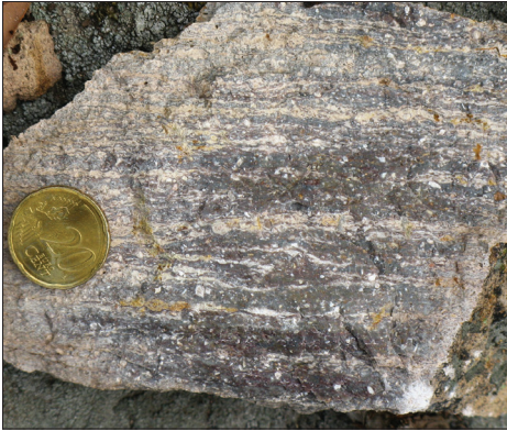
Obr. 5. Lávový prúd, v ktorom sa jaskyňa Delta nachádza, je tvorený plagioklas-biotitovým ryolitom s minimálnou pórovitosťou a výraznou páskovanou textúrou. Foto: J. Lexa Fig. 5. The Delta Cave is situated in a lava flow that is formed of plagioclas-biotite rhyolite with minimal porosity and a pronounced flow banded texture. Photo: J. Lexa
