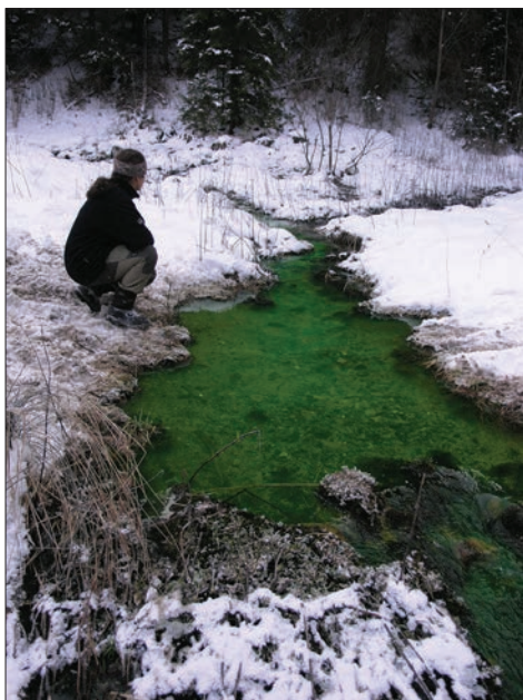
Obr. 6. Voda vytekajúca z občasnej vyvieracky za-farbená v jaskyni dňa 7. 2. 2010. Foto: P. Holúbek Fig. 6. Water flowing from an occasional spring coloured in the cave on February 7, 2010. Photo: P. Holúbek
