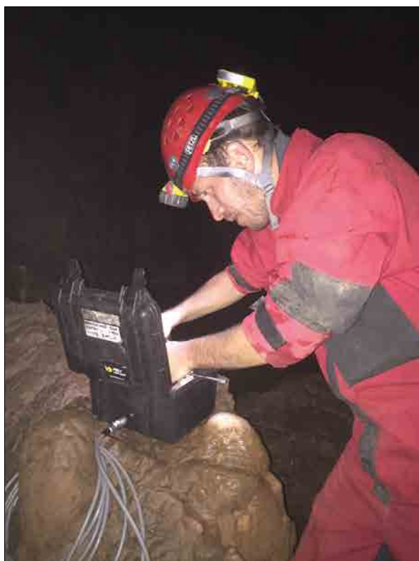
Obr. 7. Zber výsledkov a výmena batérií poľného prietokového fluorimetra GGUN-FL30 v júni 2017
