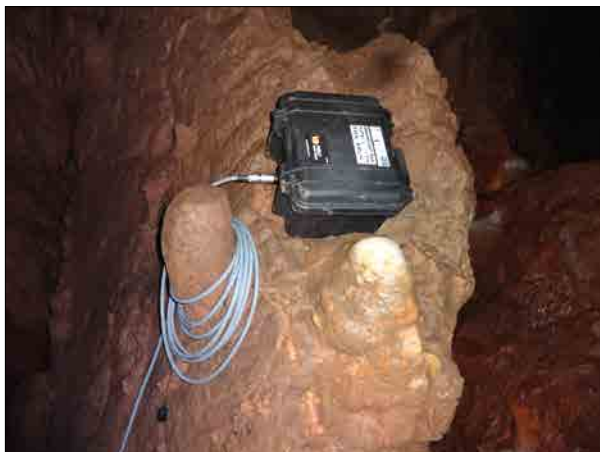
Obr. 6. Použitie kontinuálne pracujúceho poľného prietokového fluorimetra GGUN-FL30 – detailná ukážka zberu dát z pamäťovej časti zariadenia
