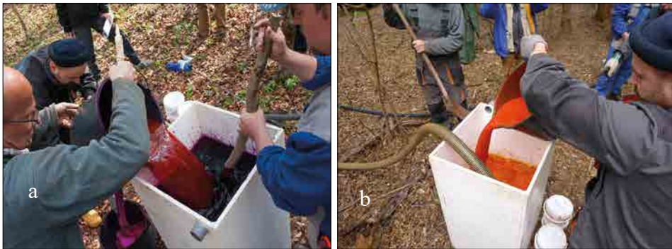
Obr. 3. Príprava farbiacich stopovacích látok pred ich aplikáciou na lokalitách a) Bezmenné prepadlisko a b) Zajačia brána
