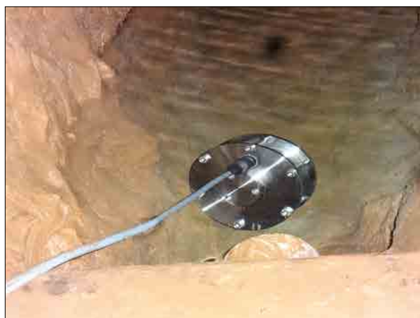
Obr. 5. Použitie kontinuálne pracujúceho poľného prietokového fluorimetra GGUN-FL30 – detailná ukážka detekčnej časti
