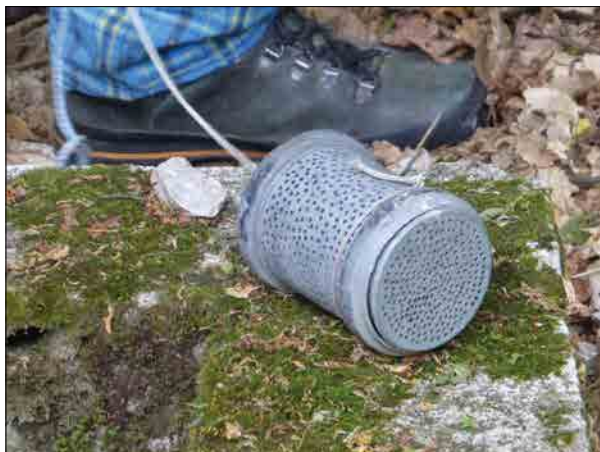
Obr. 8. Detailný pohľad na kapsulu so sorpčnou látkou, použitú na detekčných miestach 8 až 15 v rámci opisovaných stopovacích skúšok
