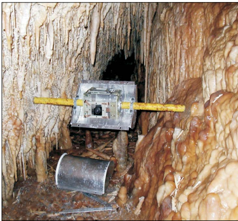
Obr. 1. Dilatometer TM-71 na zaznamenávanie tektonických pohybov, Demänovská jaskyňa slobody. Foto: P. Bella
