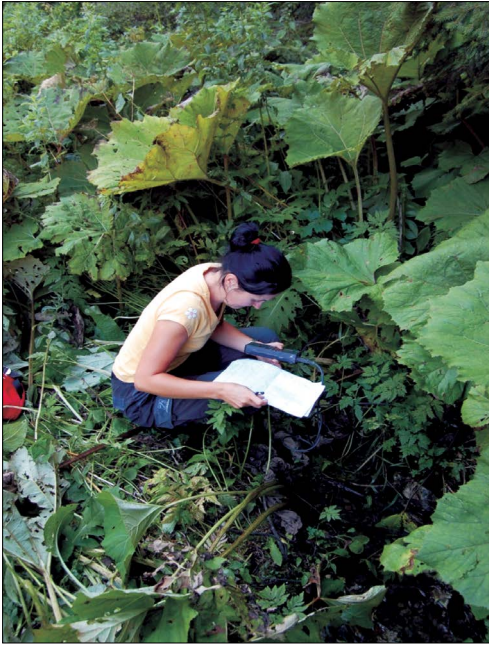
Obr. 4. Meranie mernej elektrickej vodivosti (EC) a teploty vody, prameň V-9. Foto: P. Staník
