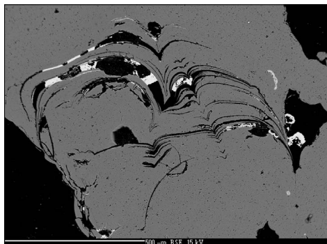
Obr. 7. Chemicky homogénny opál s nátekovitou textúrou s Ba, Al-fosfátmi (svetlosivé), BEI Fig. 7. Collomorph chemically homogenous texture of opal with Ba, Al-phosphates (light grey), BEI
