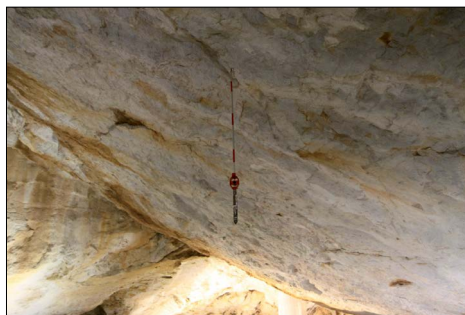
Obr. 3. Stabilizovaný meračský bod na skalnom strope v Malej sieni. Foto: J. Gašinec
