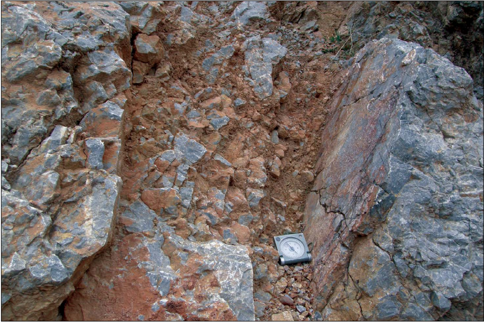
Obr. 12. Tektonická brekcia v zóne zlomu SZ – JV smeru ( 230/65^\circ ) typu poklesu, kameňolom SZ od obce Drienovec. Foto: M. Zacharov
