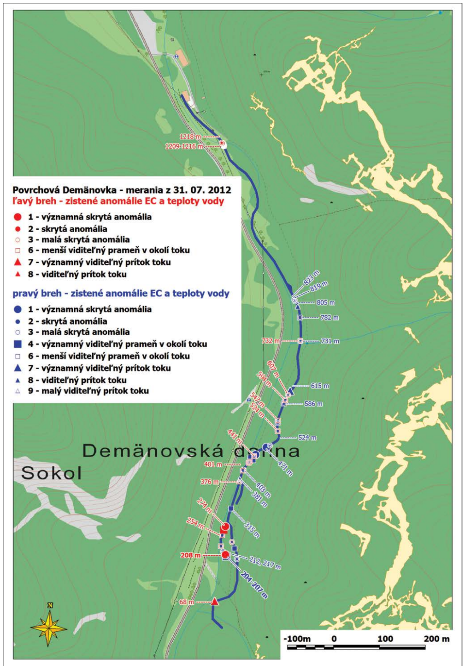
Obr. 16. Výsledky termometrických a rezistivimetrických meraní, vykonávaných na povrchovom toku Demänovky medzi Vyvieraním a Kamennou chatou dňa 31. 7. 2012
