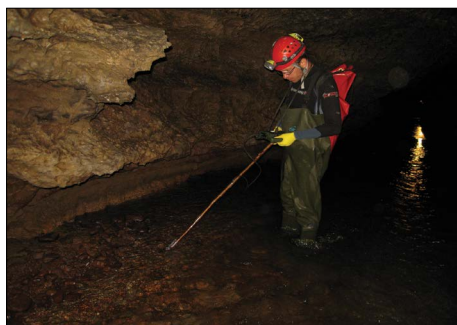
Obr. 3. Spôsob vykonávania termometrických a rezistivimetrických meraní – použitý konduktometer LF 325-A fy WTW, obsluha: J. Švasta. Foto: D. Haviarová
