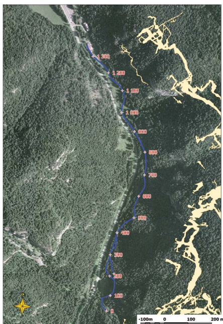
Obr. 8. Lokalizácia vzťažných bodov rezistivimetrických a termometrických meraní, vykonávaných na povrchovom toku Demänovky medzi Vyvieraním a Kamennou chatou dňa 31. 7. 2012. Čísla znázorňujú vzdialenosť v metroch od začiatku meraní
