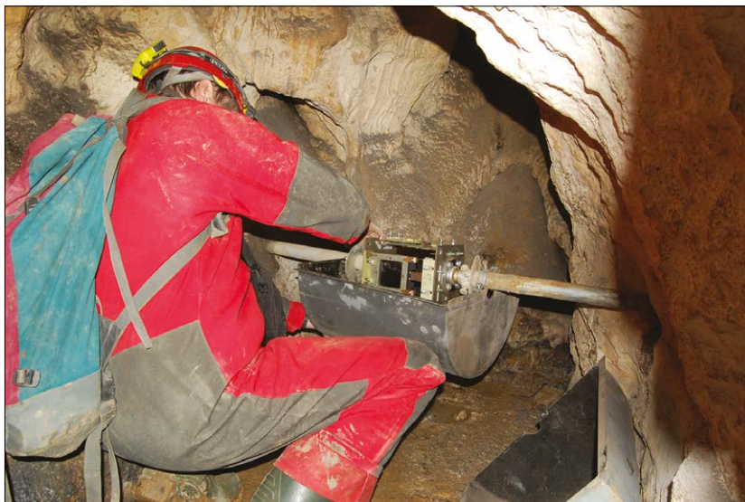
Obr. 1. Extenzometrické meradlo TM71 osadené na lokalite Liskovská jaskyňa. Foto: P. Staník Fig. 1. Extensometer TM71 type, installed in the Liskovská Cave. Photo: P. Staník
