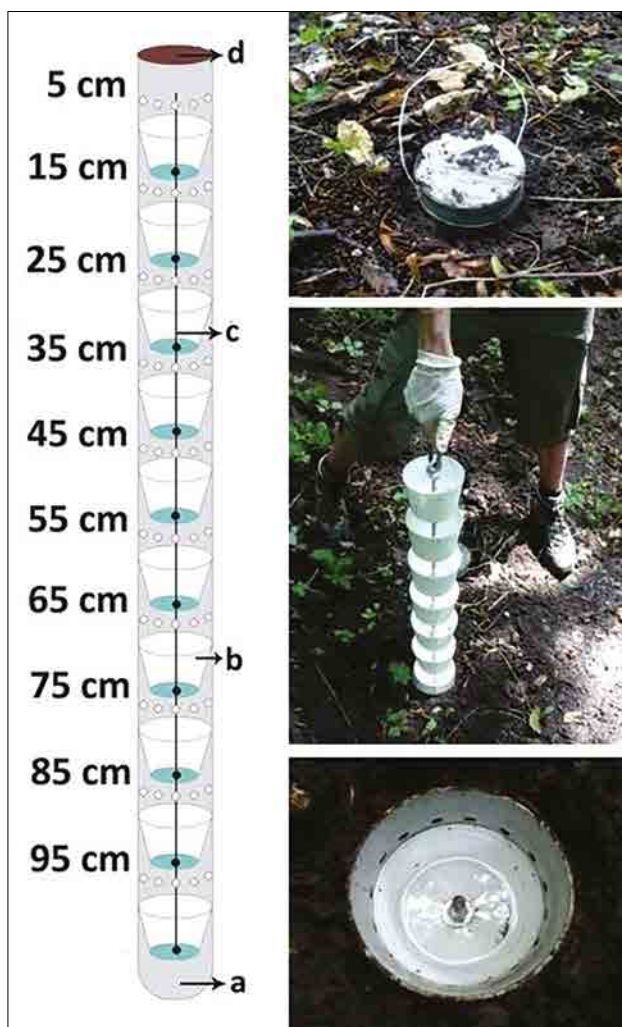
Obr. 3. Subteránna pasca na zber bezstavovcov v hlĺbkovom profile sutiny. Legenda: a – plastová rúra, b – plastová nádoba, c – kovová závitnicová tyč, d – plastový uzáver Fig. 3. Subterranean trap for invertebrates occupying the scree profile. Caption: a – plastic cylinder, b – plastic cup, c – metal rod, d – plastic lid
