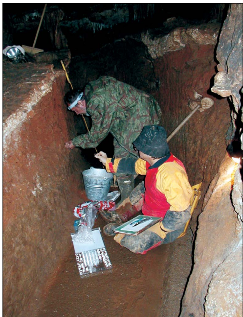
Obr. 10. Odber vzoriek jemných sedimentov na paleomagnetický výskum v Jasovskej jaskyni. Foto: P. Bella Fig. 10. Sampling of fine-grained clastic sediments for paleomagnetic research in the Jasov Cave. Photo: P. Bella
